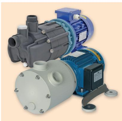
Para fluidos corrosivos, agressivos e explosivos nas construções horizontal ou submersa com acoplamento magnético ou com selo mecânico. Modelos de bombas em várias construções para aplicações industriais que suportam temperaturas de até 100°C, vazões de até 50m<sup>3</sup>/h e são autoescorvantes até 6m.
