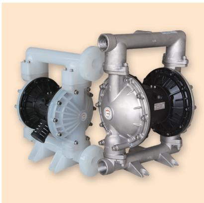
Bombas pneumáticas, metálicas ou plásticas indicadas para a transferência de fluidos químicos, corrosivos, inflamáveis, abrasivos, viscosos ou com a presença de sólidos em suspensão. Disponíveis em modelos padrão ou com execução especial, sanitárias, tipo *flap* ou duplicadoras de pressão.
