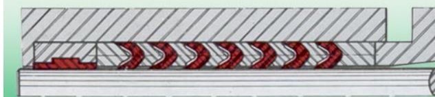
FIGURA 8 - Vedação típica com anéis em "V" com bucha dianteira de restrição. Typical plunger sealing with "V" frontal restriction bushing.
