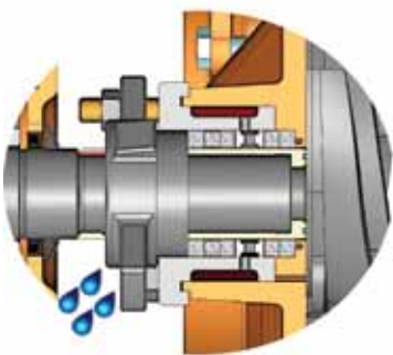
Gaxeta bem regulada vazava até 30 a 60 gotas/min. Properly adjusted packings spill up to 30/60 drops/minute.
